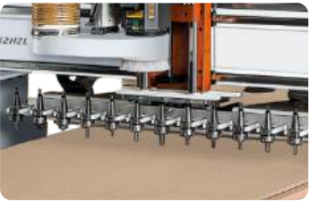
Рядный инструментальный магазин на 12 ячеек: отдельное оснащение для каждой операции, автоматическая смена инструмента без задержек.
