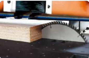
а. Макс. длина вертикального раскrojа: 3100 мм Макс. длина горизонтального раскrojа: 1800 мм
