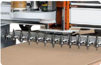
а. Рядный инструментальный магазин на 12 ячеек: отдельное оснащение для каждой операции, автоматическая смена инструмента без задержек.
