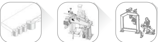
3+1 Пресс-ролики Двухцветный самоочищающийся дозатор клея Двойная обкатка углов Round узких кромок
