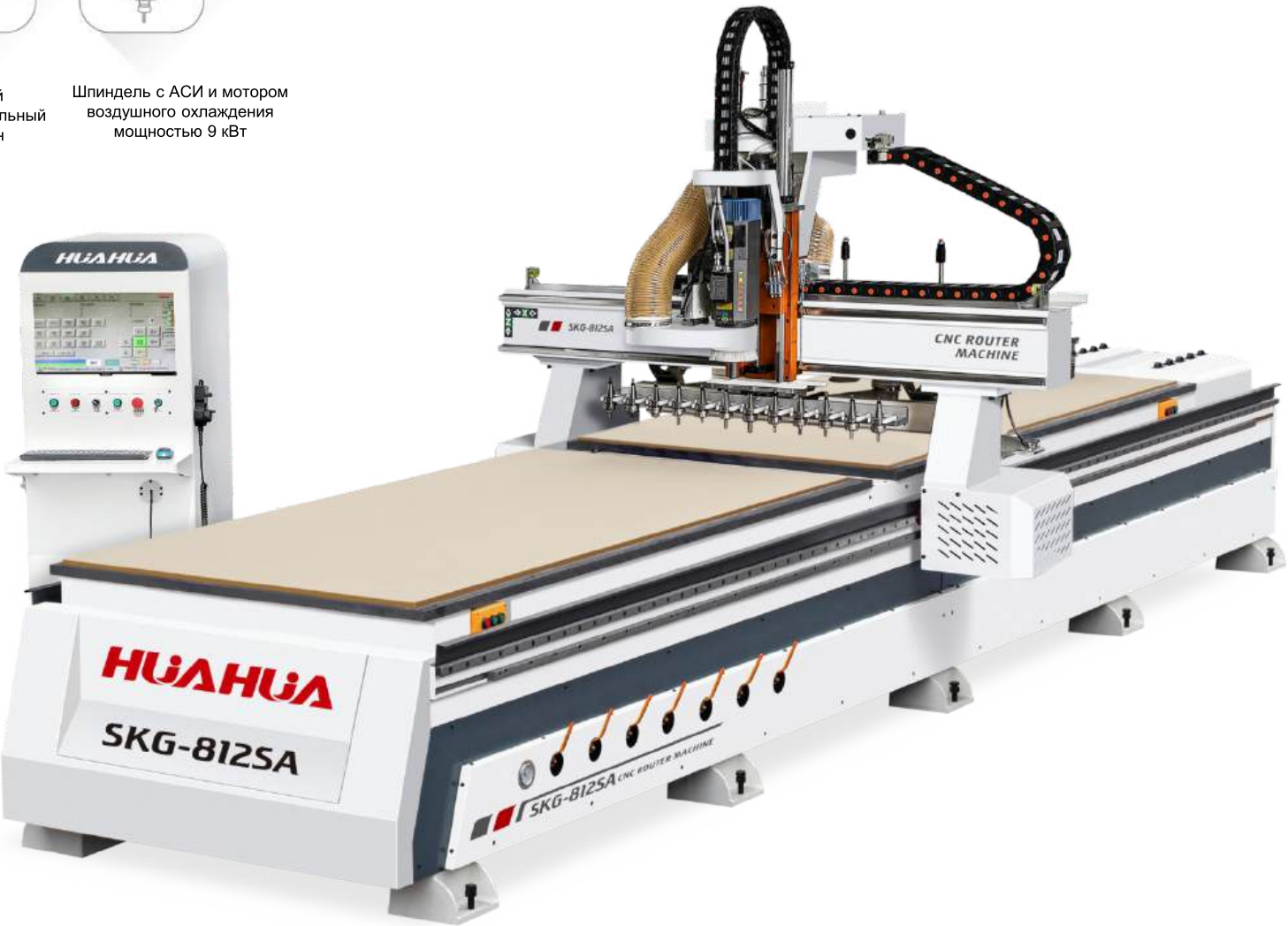
Рядный инструментальный магазин на 12 ячеек: отдельное оснащение для каждой операции, автоматическая смена инструмента без задержек.
