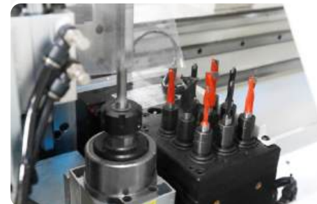
Высокоточная нижняя сверлильная голова
