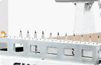
б. Шпиндель с автоматической сменой инструмента (АСИ) и 12-позиционный линейный инструментальный магазин, обеспечивающий выполнение разнообразных операций: резку, сверление, фрезерование пазов, 3D-обработку и другие точные работы.
