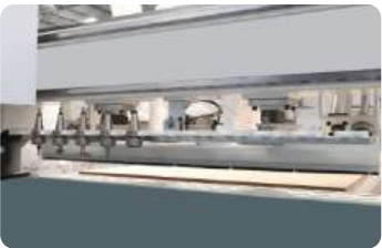
Рядный инструментальный магазин на 12 ячеек. Автоматическая смена инструмента и непрерывная обработка. Отвечает различным требованиям применения.
