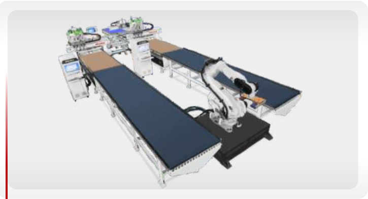
a Станки с ЧПУ, подключенные по схеме «один-к-двум», с манипулятором
