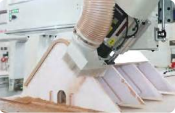
а. Шпиндель фрезерный с поворотом на 180° и пылезащитным кожухом, рабочий ход по оси Z 500 мм, обеспечивающий выполнение операций горизонтального и 45-градусного сверления с левой стороны.
