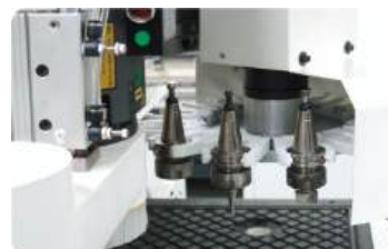
б. Конусный инструментальный магазин на 12 ножей с автоматической сменой.
