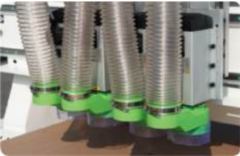
Четыре шпинделя могут использоваться для обработки пазов, фрезерования, раскроя, сверления и т.д.
