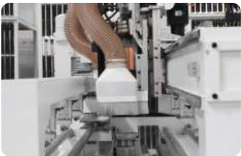
Одна высокоточная сверлильная головка для каждой стороны. Эффективная обработка. Не нужно переворачивать панели. Позволяет сверлить отверстия с двух сторон.
